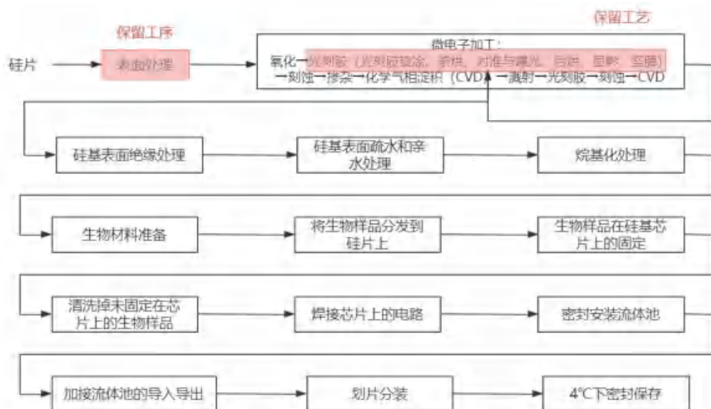
图 2-8 硅片为基材的生物芯片的生产及研发工艺流程
